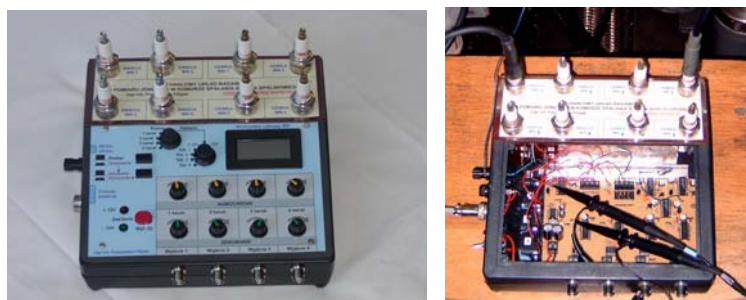
Rys. 3. Układ pomiaru jonizacji drugiego typu (drugiej generacji) Fig. 3. Second generation of ionization measurement system
